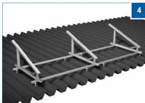
Successivamente posizionare la piastrina di fissaggio 9785-W 26 sui colli delle filettature e serrare con un dado flangiato zigrinato Din 9345. Coppia di serraggio 14-16 Nm.
