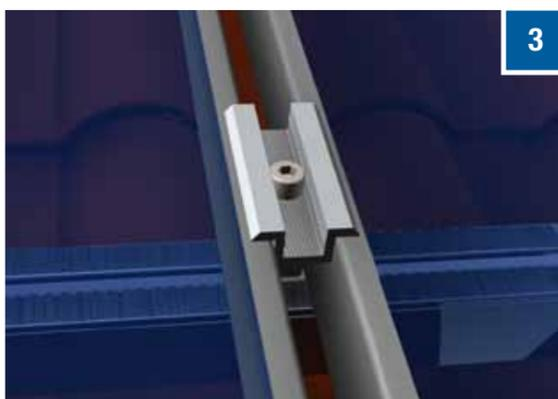
In alternativa inserire e avvitare nella scanalatura superiore del profilato Morsetto 9742-ClipE a scatto (coppia di serraggio massima: 18 Nm, a seconda del produttore dei pannelli) (figura 2.2).
